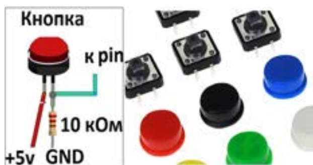
Рис. 1. Схема подключения тактовой кнопки к микроконтроллерной плате
